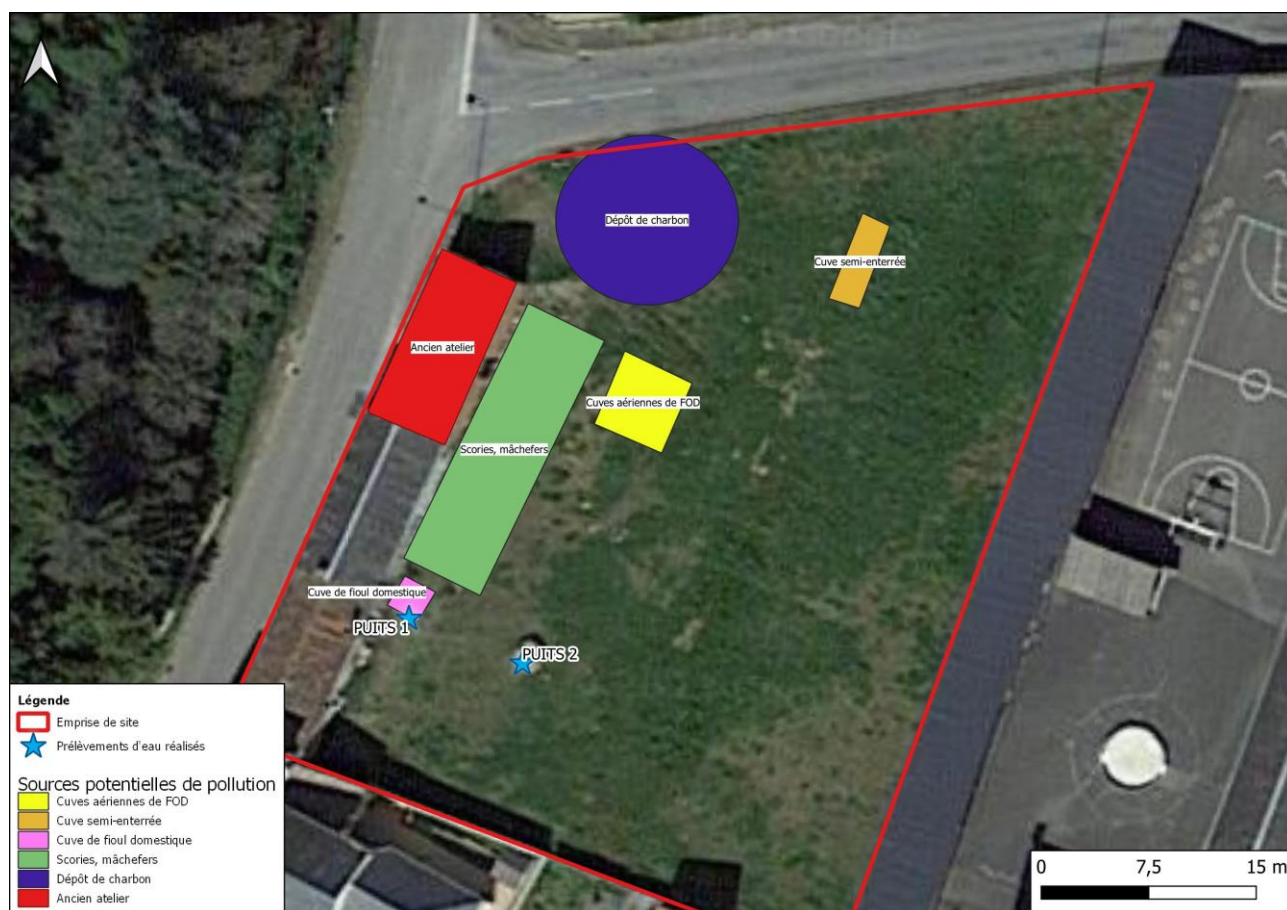
FIGURE 20 : PLAN DES INVESTIGATIONS SUR LES EAUX SOUTERRAINES
