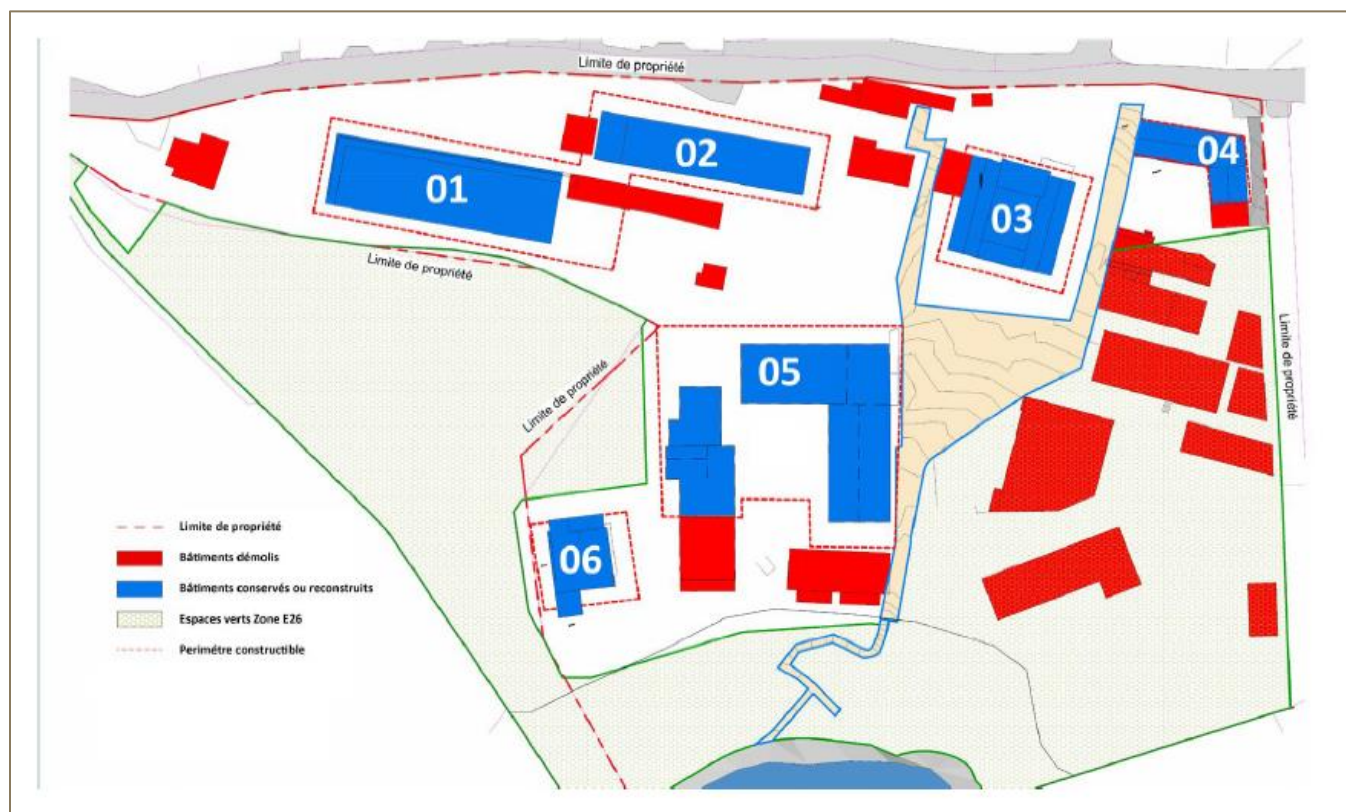
Figure 2 : Relevé des bâtiments à démolir (en rouge) et des bâtiments réhabilités (en bleu)
