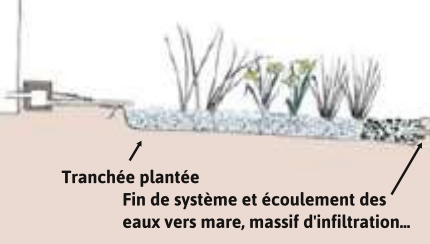
Schéma d'un assainissement par tranchée plantée.
