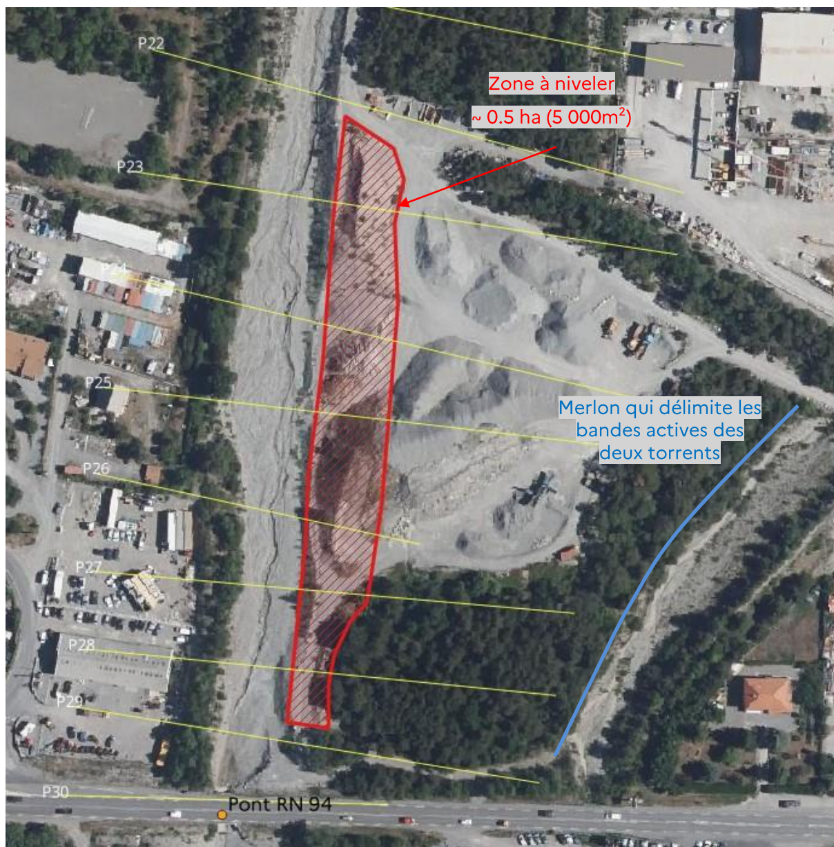
fig. 14 : Localisation des dépôts de curage à araser en rive gauche du Dévezet
