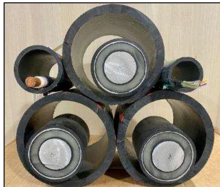
Figure 4 : Photographie d'un ensemble souterrain 63 kV PEHD
