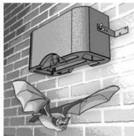
Figure 4 : Gîte accroché sur une surface plane verticale
