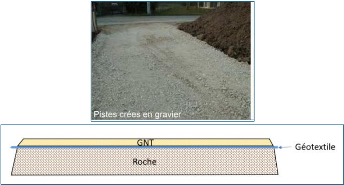
Figure 20 : Exemple de piste créée en gravier et plan de coupe
