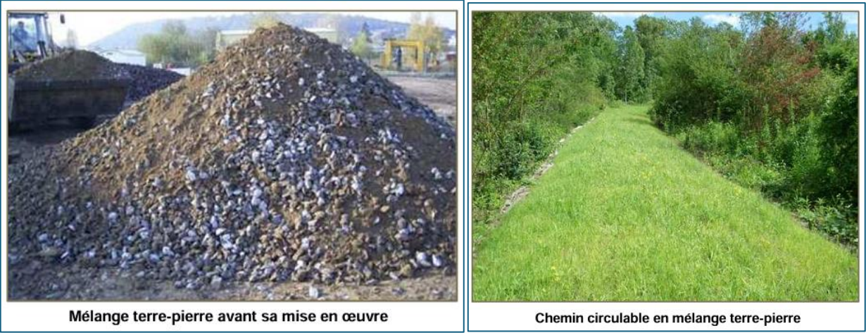
Figure 19 : Exemple de mélange terre-pierre et chemin circulaire
