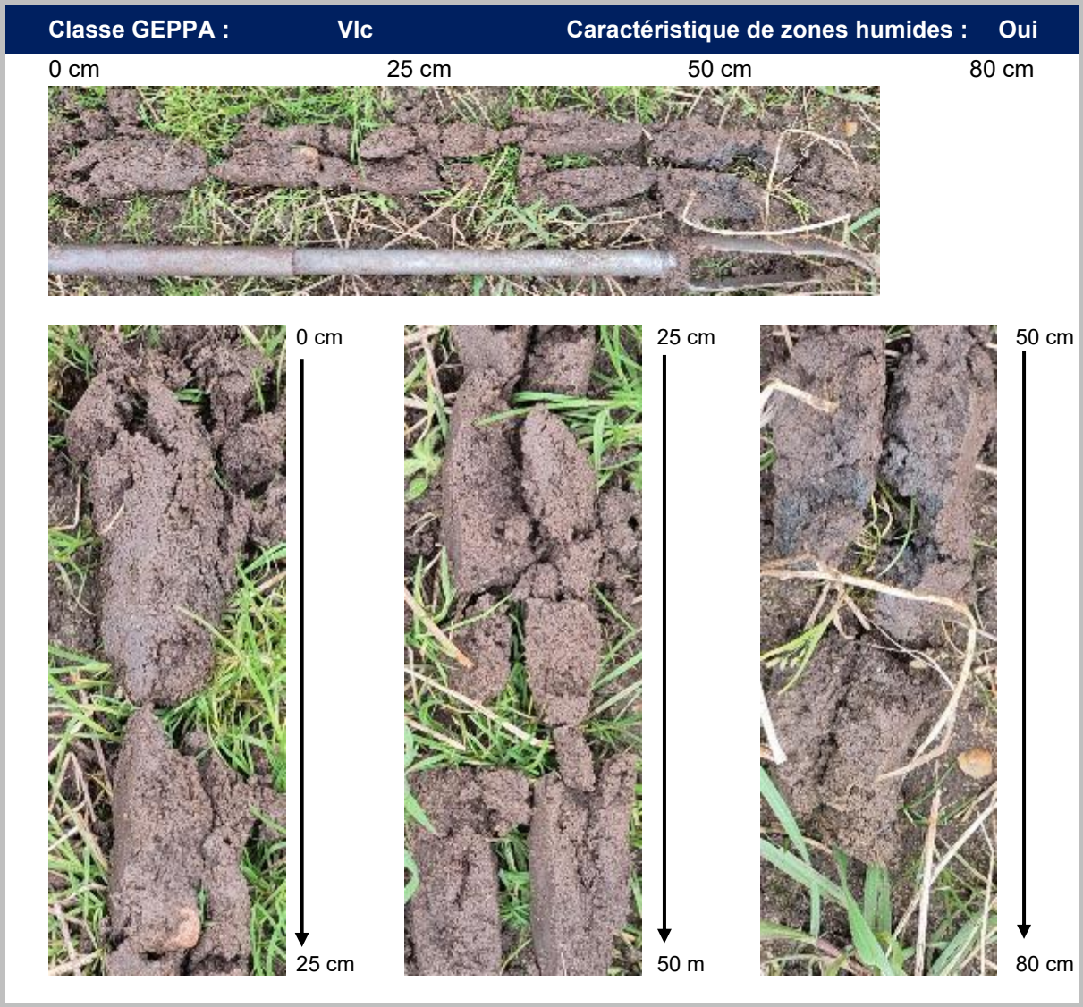
Figure 2 : Description du sondage S16 représentatif des sols de la zone d'étude appartenant à la classe Vb de la table du GEPPA
