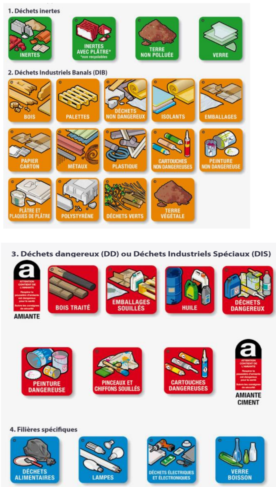
Figure 7 : Les différents types de déchets que l'on retrouve sur le chantier
