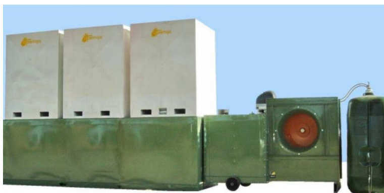
Photo 8 : Séchoir à flux d'air chaud vertical avec brûleur à gasoil
