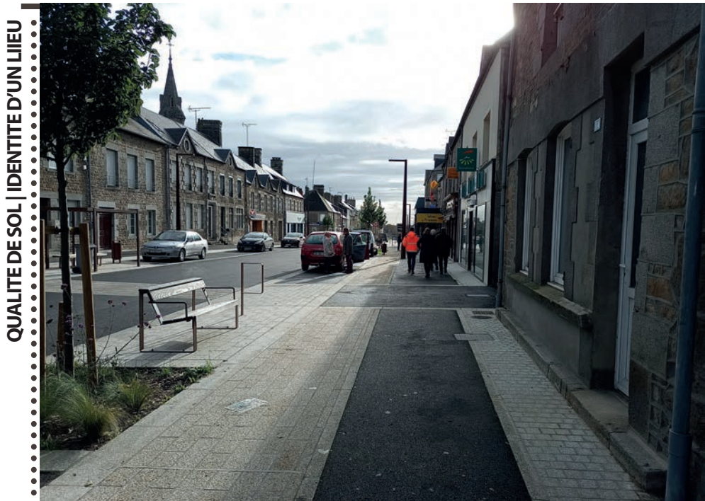
Trottoirs en béton et pieds de façade pavés en béton avec ou sans écarteurs
