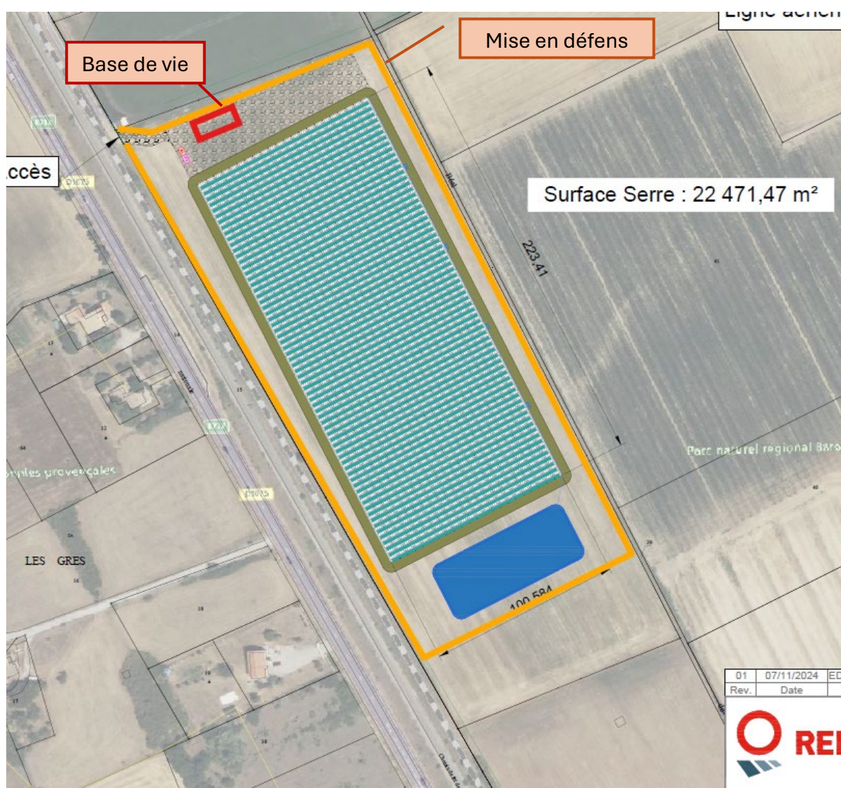
Illustration 1 : Mise en défens du projet en phase chantier
