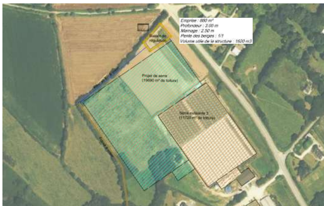
Carte 1 : Plan du bassin de régulation tel que conçu dans le cadre de la déclaration de 2015
