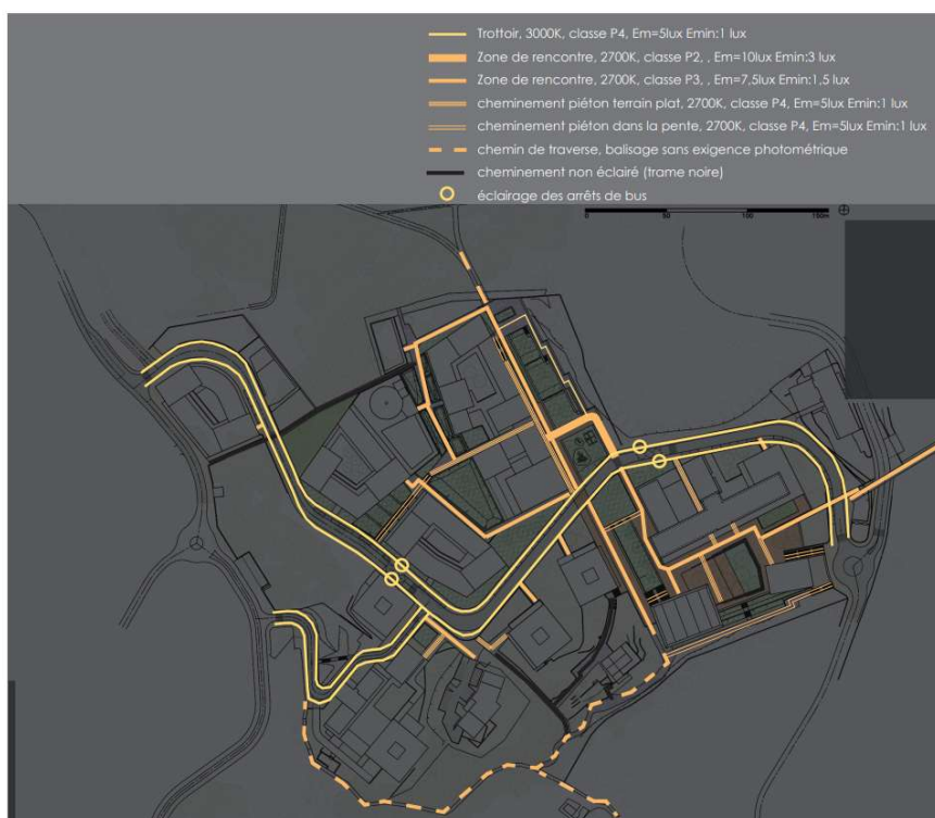
Figure 71 : Principe d'éclairage des parcours piétons
