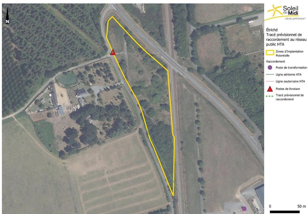
Figure 31 : Tracé prévisionnel du raccordement électrique
