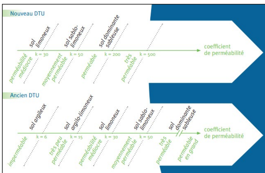
Figure 12 : Classes de perméabilité d'après DTU 64.1 de 2013
