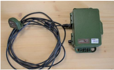
Figure 17 : SM4 utilisé pour l'inventaire des chiroptères
