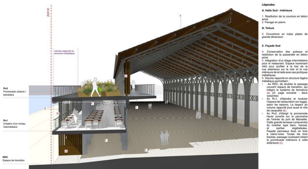
Coupe perspective du principe de projet de la façade sud de la halle sud
