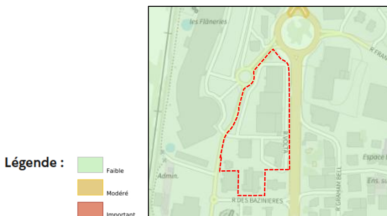
Risques "retrait et gonflements des argiles" sur le territoire de la Roche-sur-Yon (georisques.gouv.fr)
