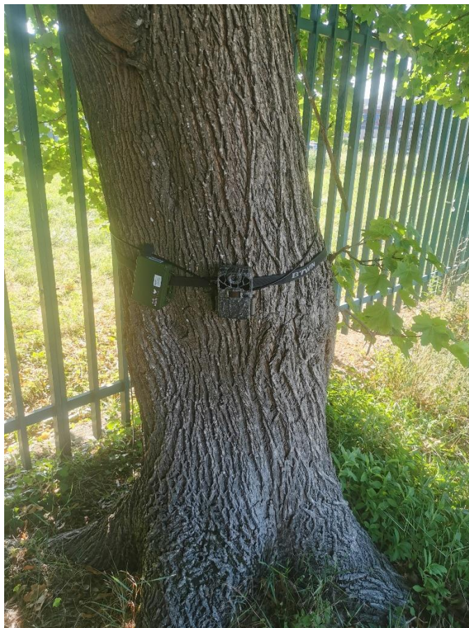
Illustration de l'enregistreur Song Meter Mini Bat de Wildlife acoustics installé sur le tronc d'un érable
