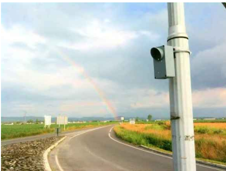
Exemple de caméra d'enregistrement utilisée pour les comptages directionnels
