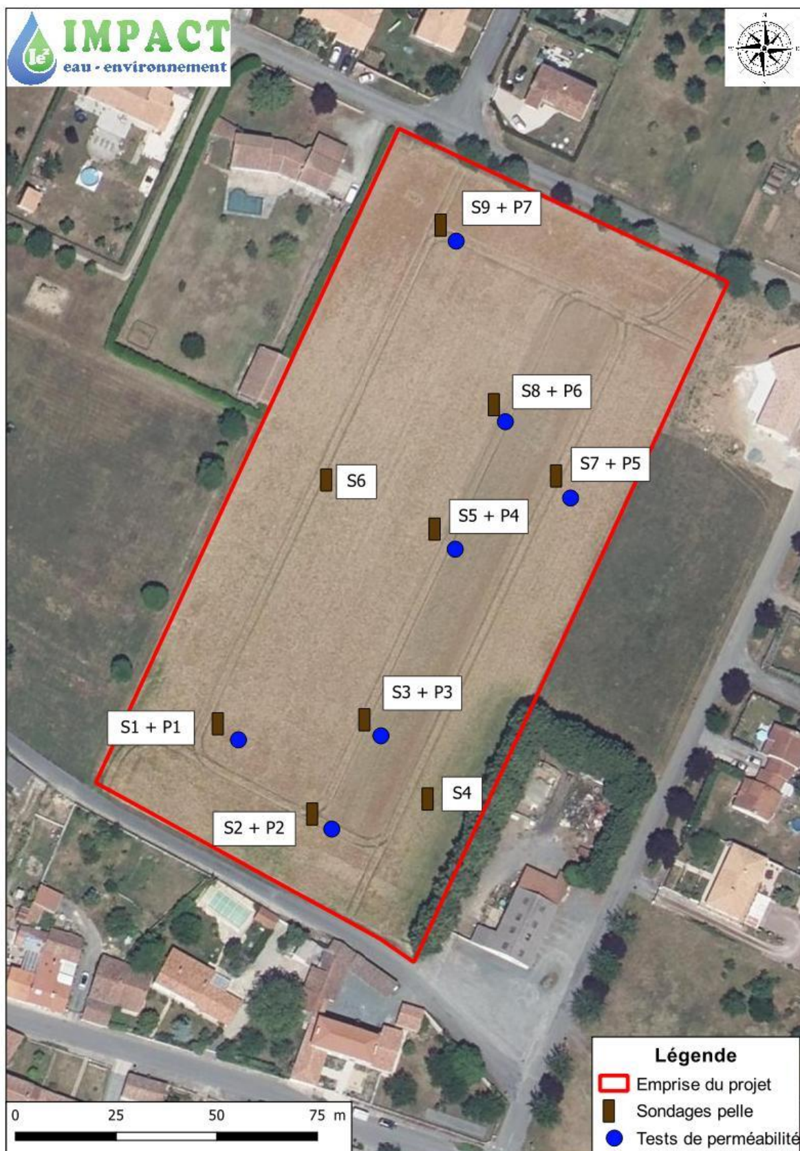
Figure 3. Localisation des sondages et essais de perméabilité
