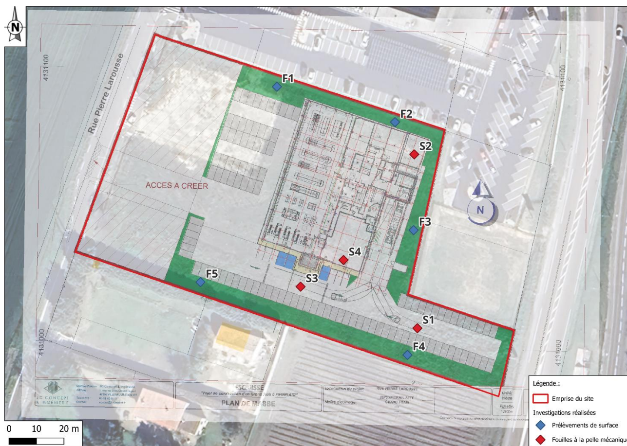
Figure 20 : Localisation des investigations réalisées
