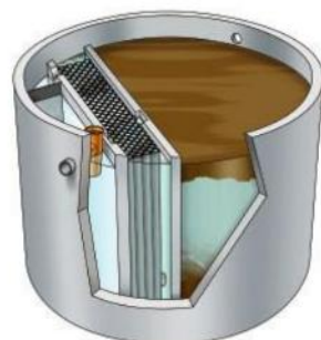
Figure 31 : Microstation à culture fixée (EPUR®)
