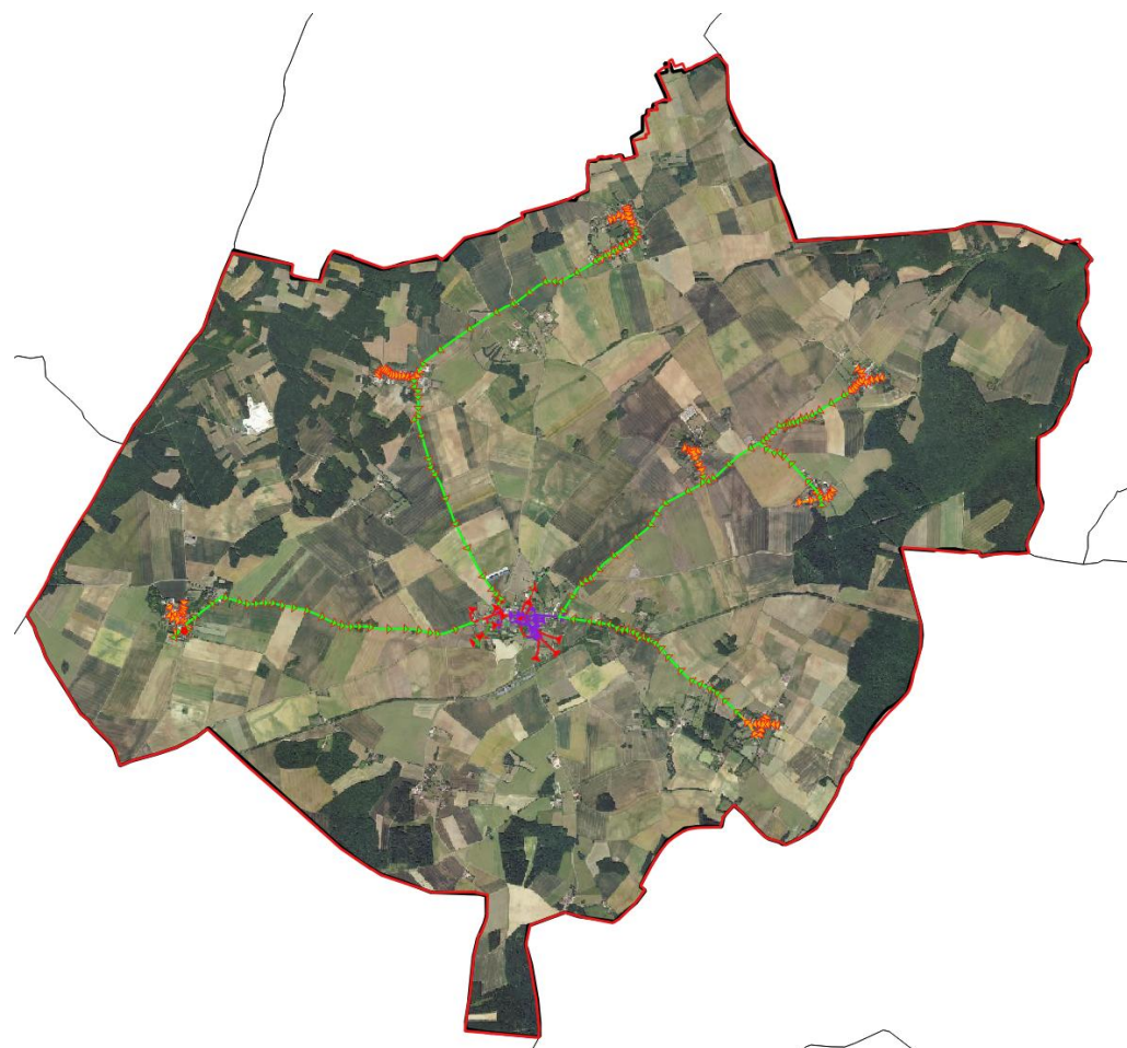
Figure 15 : représentation des projets avec réseau de refoulement vers le bourg
