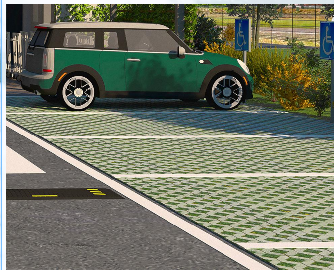
Stationnements Evergreen ou Terre-pierre pour limiter l'imperméabilisation du site
