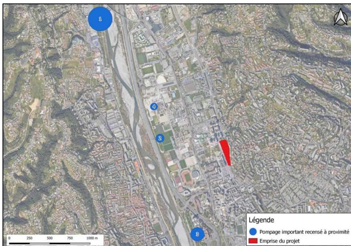
Figure 15 : Pompages recensés à proximité de la zone d'étude hors forage de géothermie (source : GINGER BURGEAP)
