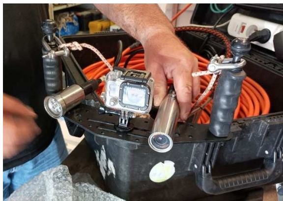
Figure 37 : Eclairage LED, caméra d'acquisition GoPro et caméra de retour vidéo
