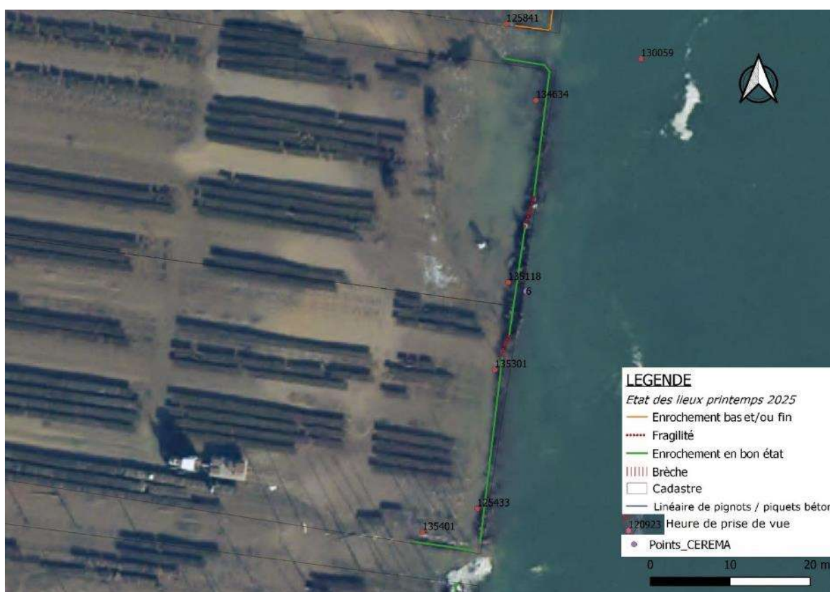
Carte 6 : détail de l'enrochement existant sur la zone numérotée 3 sur la Carte 3
