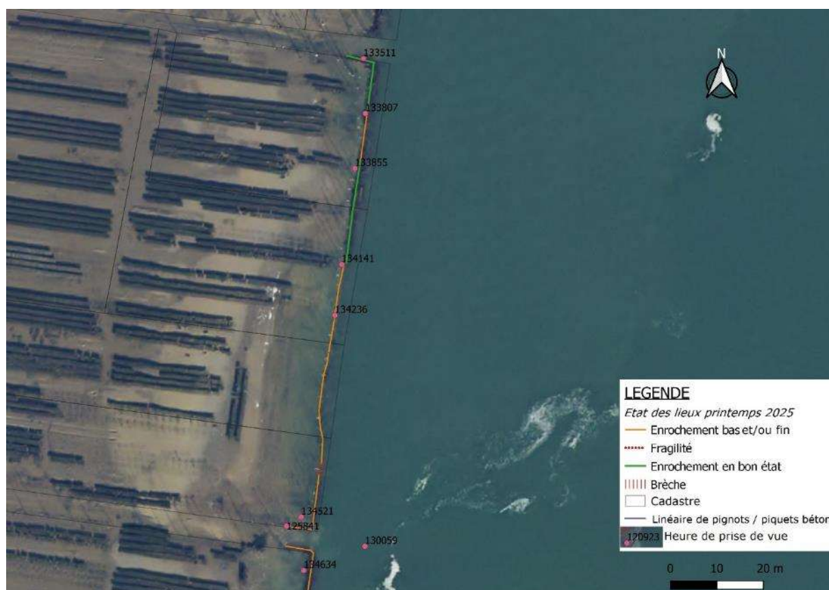
Carte 5 : détail de l'enrochement existant sur la zone numérotée 2 sur la Carte 3
