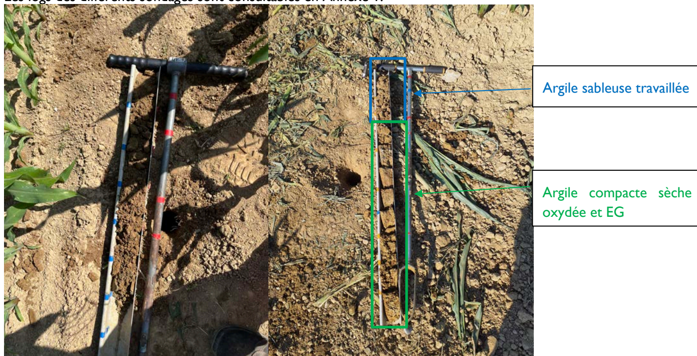
Figure 10 : illustrations de sondages levés au droit de la parcelle : à gauche, sondage S3 interceptant uniquement l'horizon de sol remanié // à droite, sondage 23 d'une profondeur de 1,20m pour interpréter les différents horizons présents (Source : ENVOLIS)
