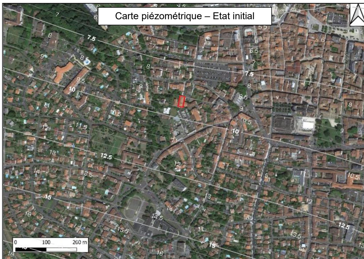
Figure 16 : Calage piézométrique – Etat initial
