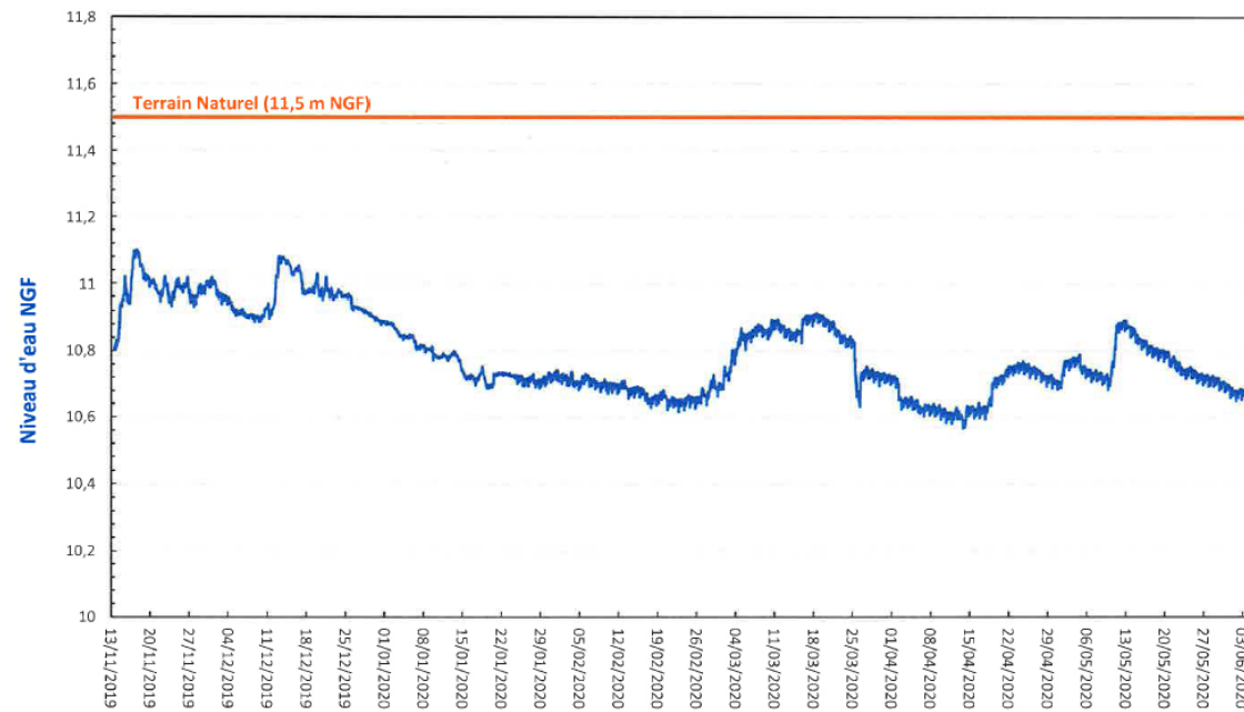
Figure 5 : Suivi piézométrique par sonde automatique au droit de PZ1 (INGESOL)
