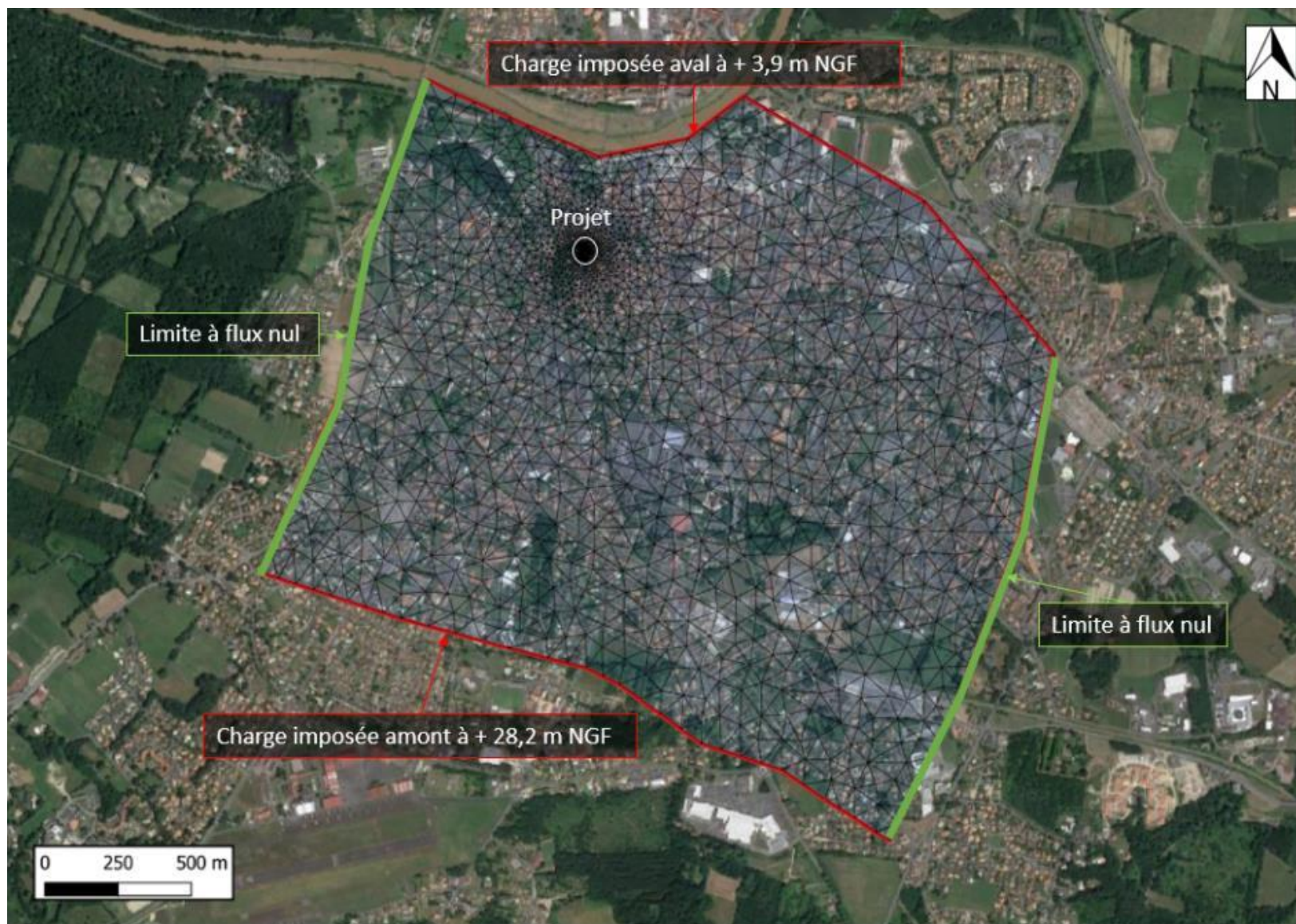
Figure 7 : Conditions aux limites du modèle réalisé
