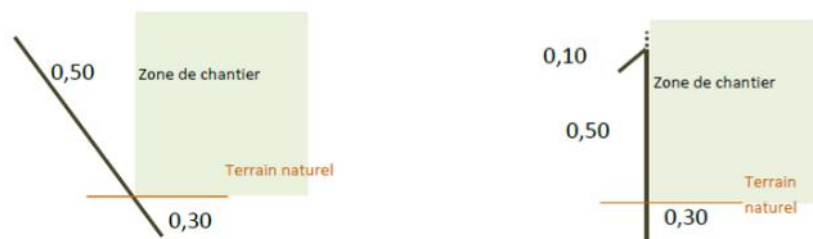
Figure 15 : Principe et caractéristique des clôtures contre l'intrusion des batraciens
