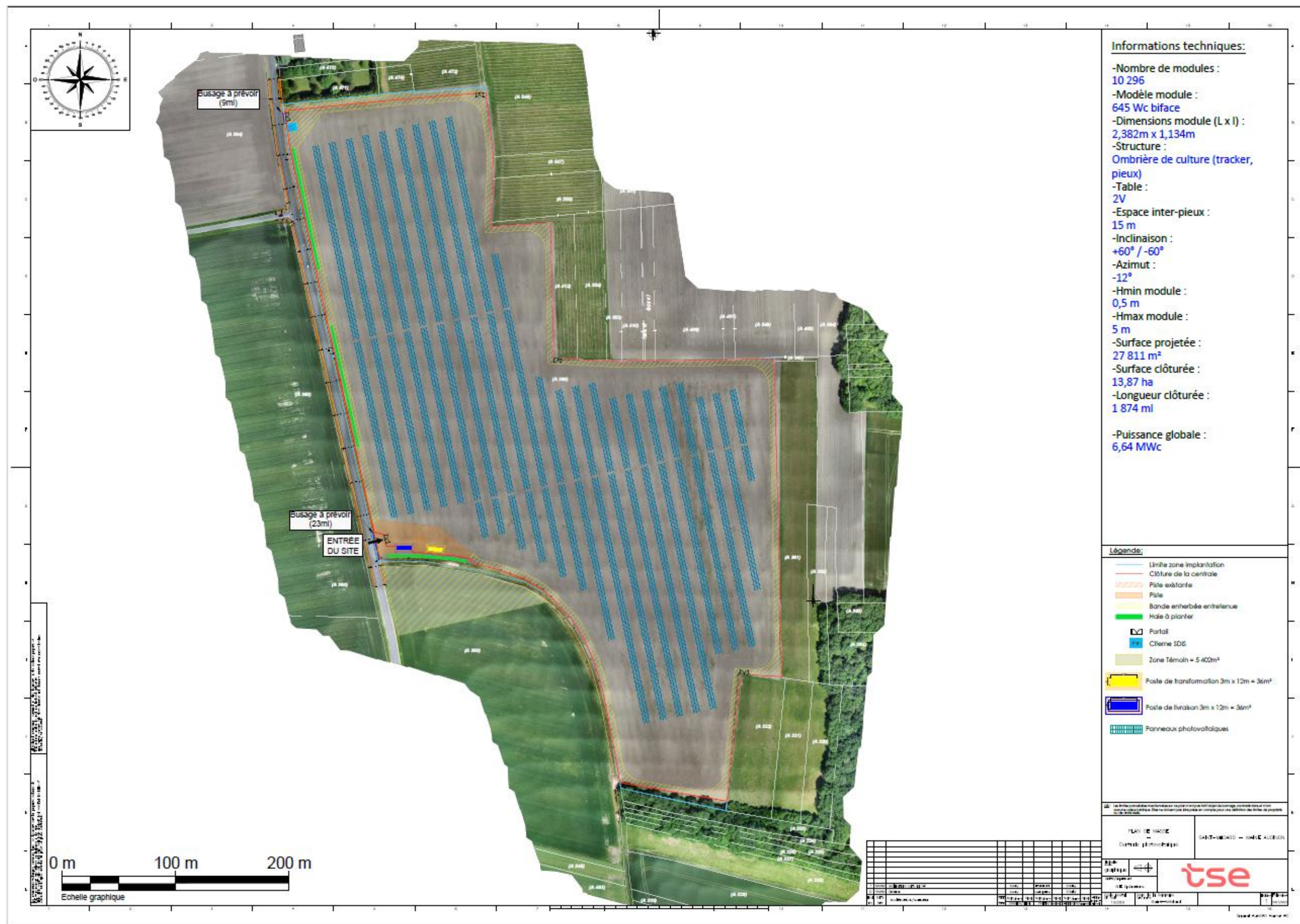
Carte 9 : Plan masse des ombrières agrivoltaiques (Source : TSE)
