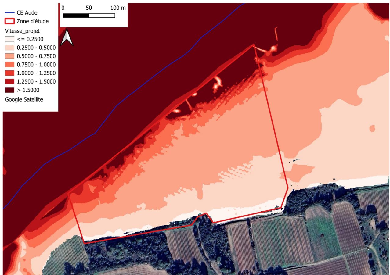
Figure 12 : Vitesses des écoulements état projet Q_{PSS}
