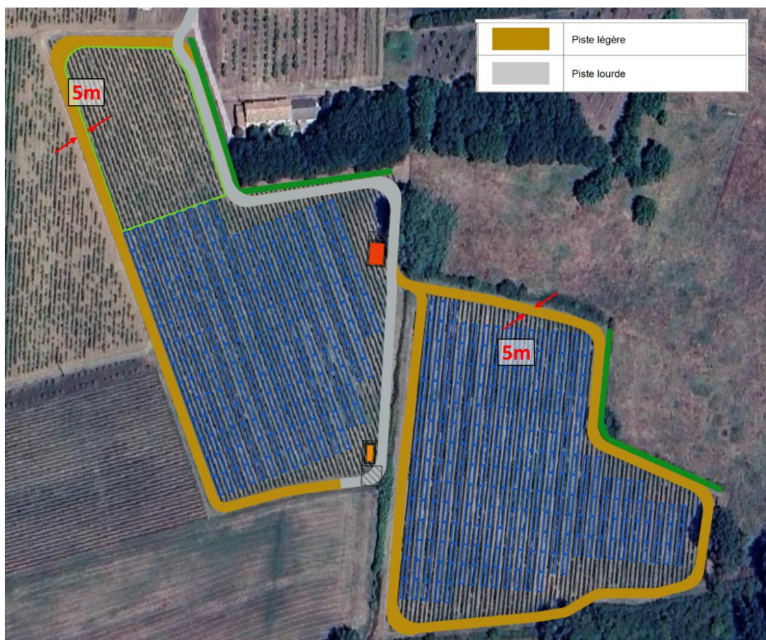
Figure 27 : Chemin d'exploitation de largeur 5.0m (Source : Sun'Agri)
