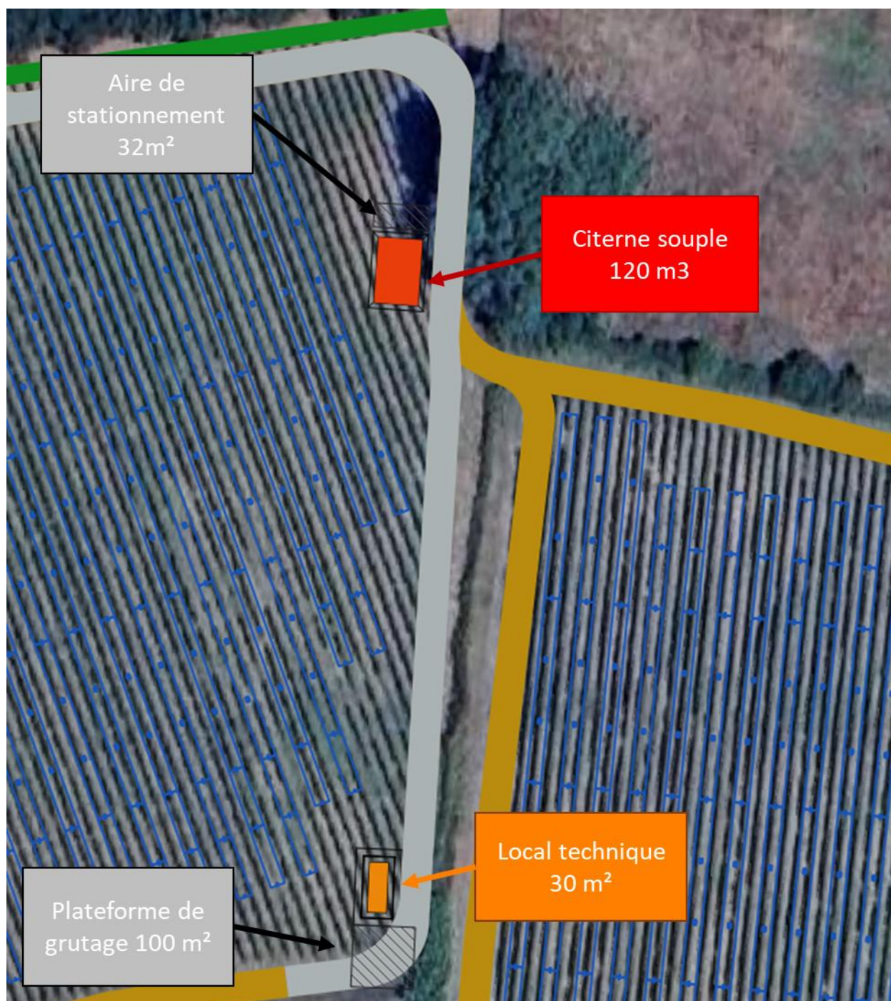
Figure 28 : Chemin d'accès et chemin d'exploitation autour de la structure agrivoltaïque (Source : Sun'Agri)
