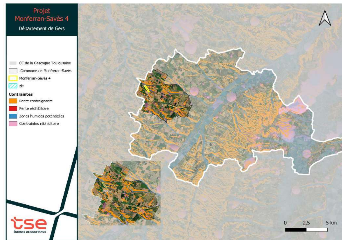
Figure 21 : Cartes des contraintes rédhibitoires du projet
