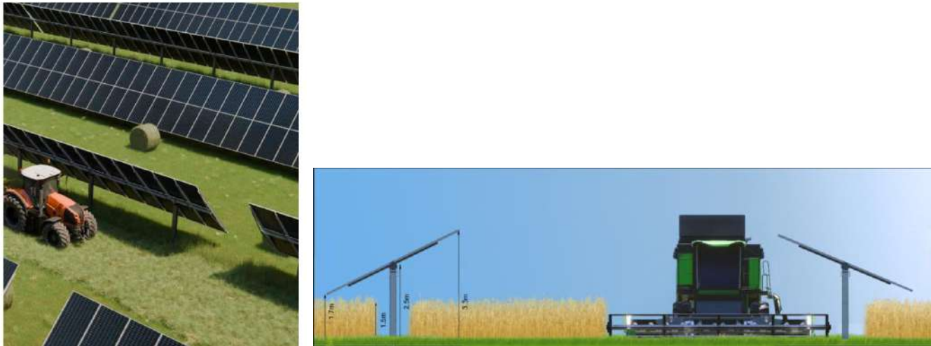
Figure 22 : Vue 3D et coupe d'une Ombrière de culture
