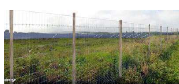
Illustration 12 : simulation d'une clôture en piquets de châtaignier et grillage à maille 5 x 10 cm (ursus lourd) de 2 m de haut (source : Cahier de recommandations – Etude de la sensibilité des paysages du Gers au développement des parcs photovoltaïques au sol (agrivoltaïsme compris), © Isabel Claus, paysage Atelier Osmia, graphisme)
