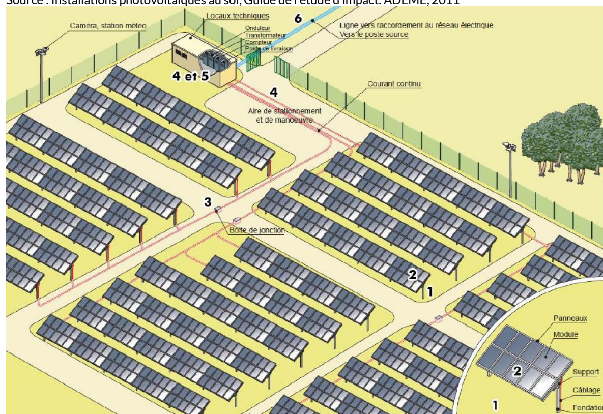
Figure 28 : Schéma de principe d'une installation-type photovoltaïque
