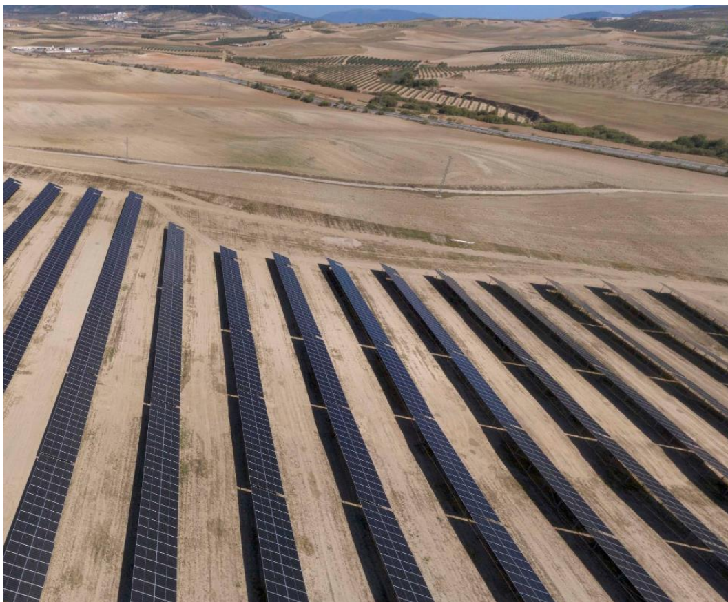
Figure 45 : Illustration du montage d'une centrale agrivoltaïque de trackers à Alhendin en Andalousie (climat méditerranéen) en Espagne (source : BayWa r.e.)
