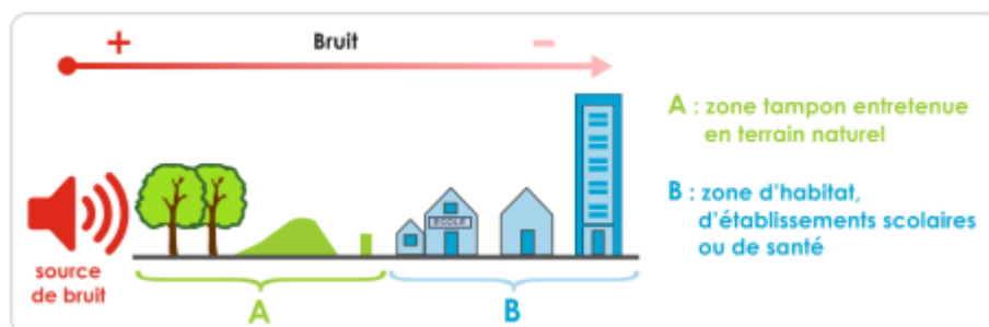
Figure 11 : Schéma d'aménagement pouvant permettre de limiter l'exposition aux bruits (Source : Extrait du PLUi-H de Toulouse métropole)
