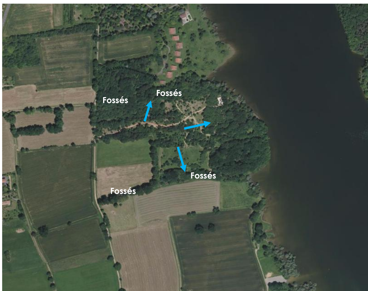
Figure 16 : Ecoulement des eaux pluviales
