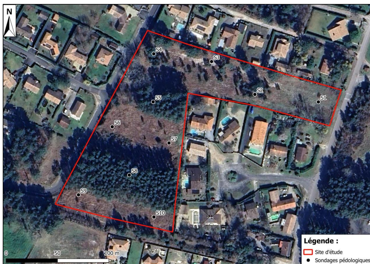
Figure 18 : Localisation des sondages pédologiques – vue aérienne actuelle
