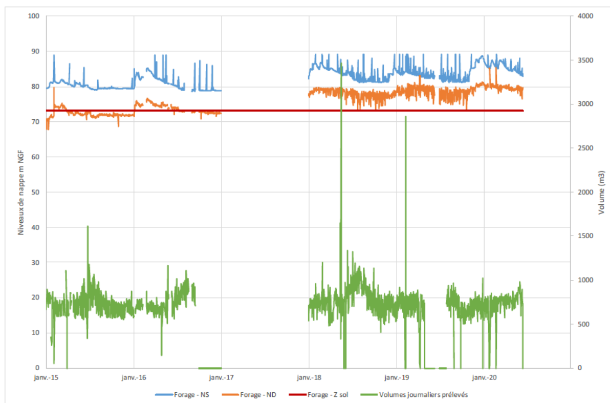
Figure 12 : Evolution des niveaux statiques et dynamiques du forage de Roche (source : AVP Roche Suez, 2022)
