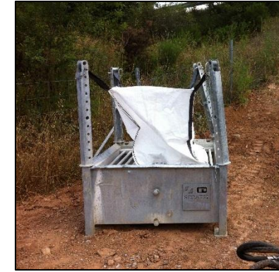
Exemple de bac de lavage pour toupies béton
