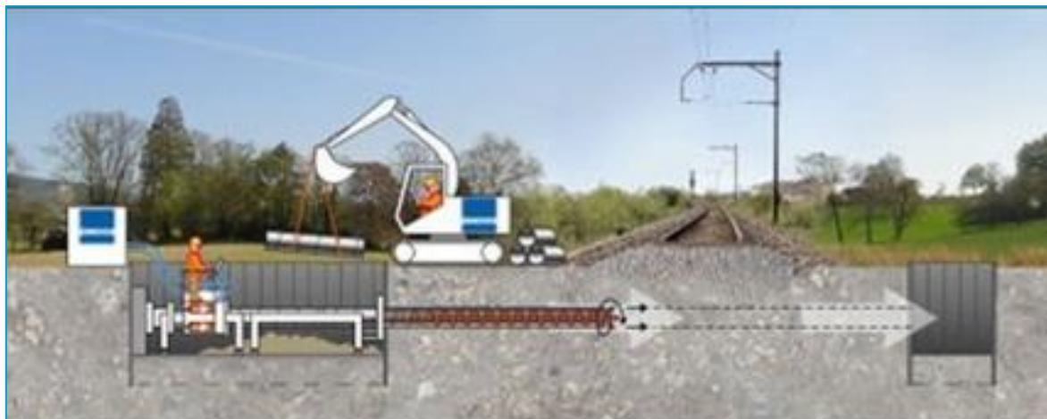
Figure 27 : Schéma d'un fonçage (Source : RTE)
