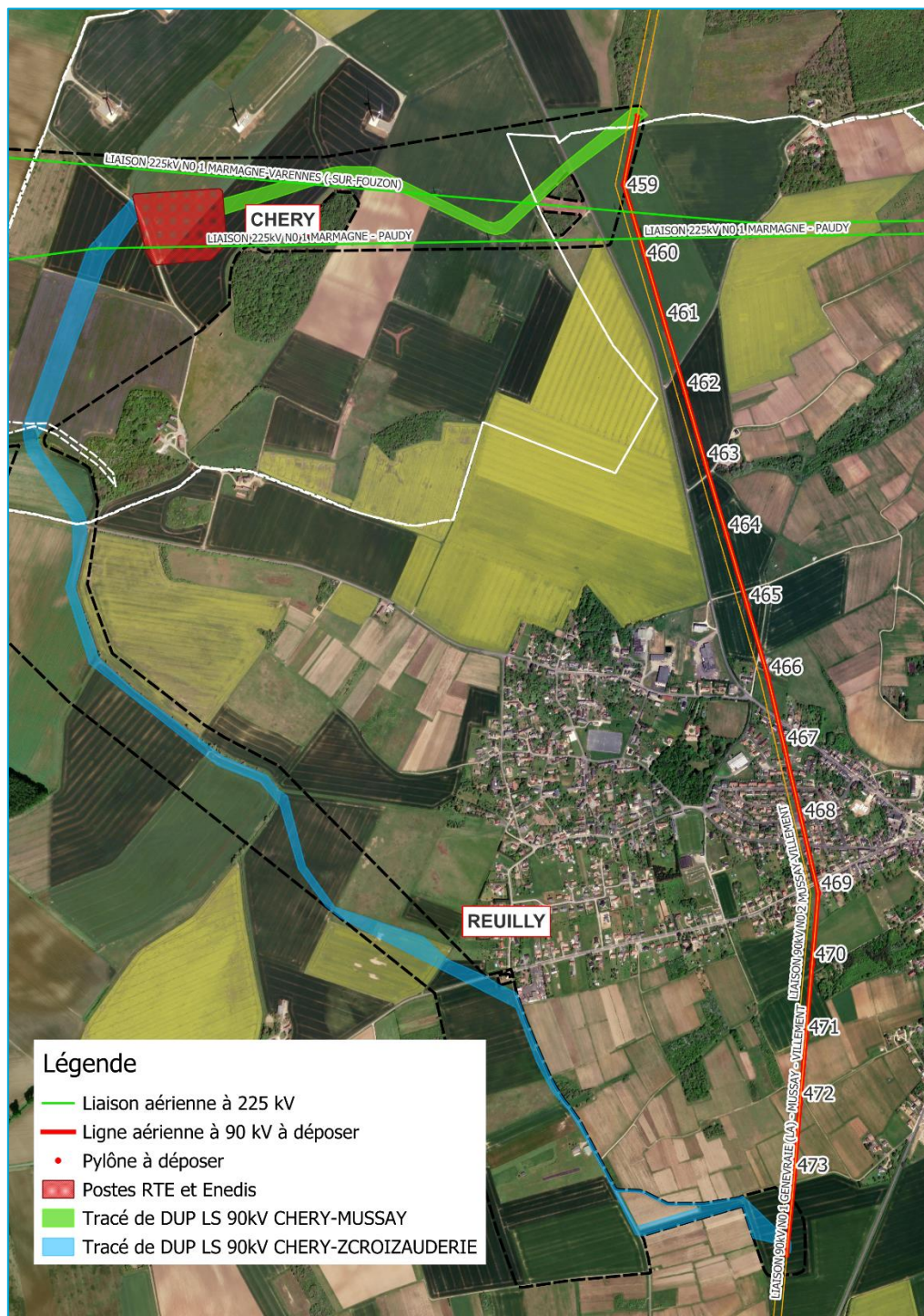
.Figure 11 - Tronçon à déposer de la ligne aérienne MUSSAY- VILLEMENT C1 (Source : RTE)
