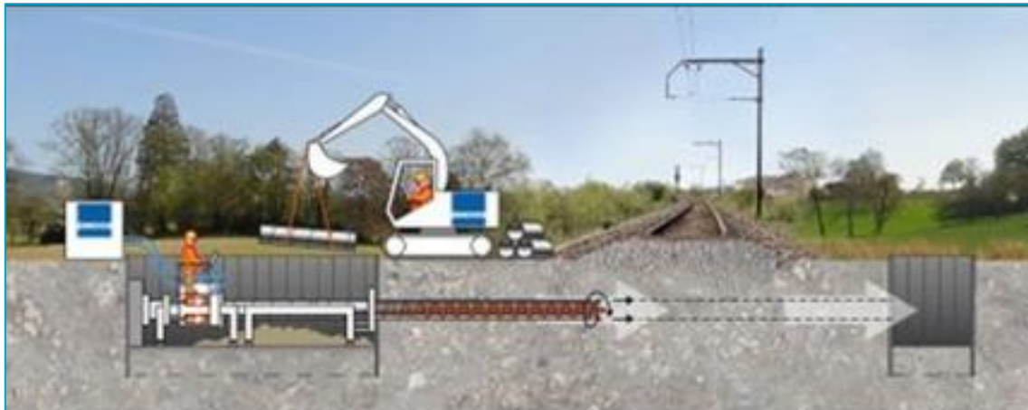
Figure 20 - Schéma d'un fonçage (Source : RTE)
