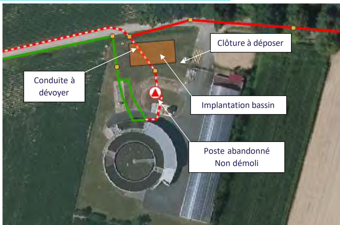
Figure 28- Implantation du bassin
