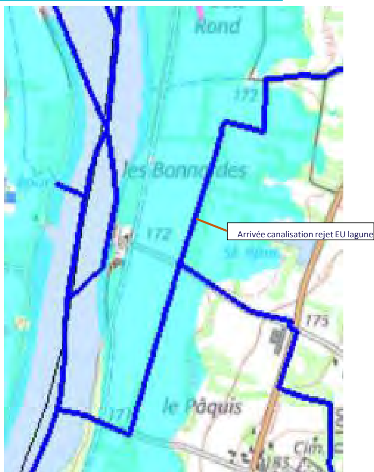
Figure 32 – Localisation de l'arrivée du rejet de la station de Mogneneins lagune dans le cours d'eau
