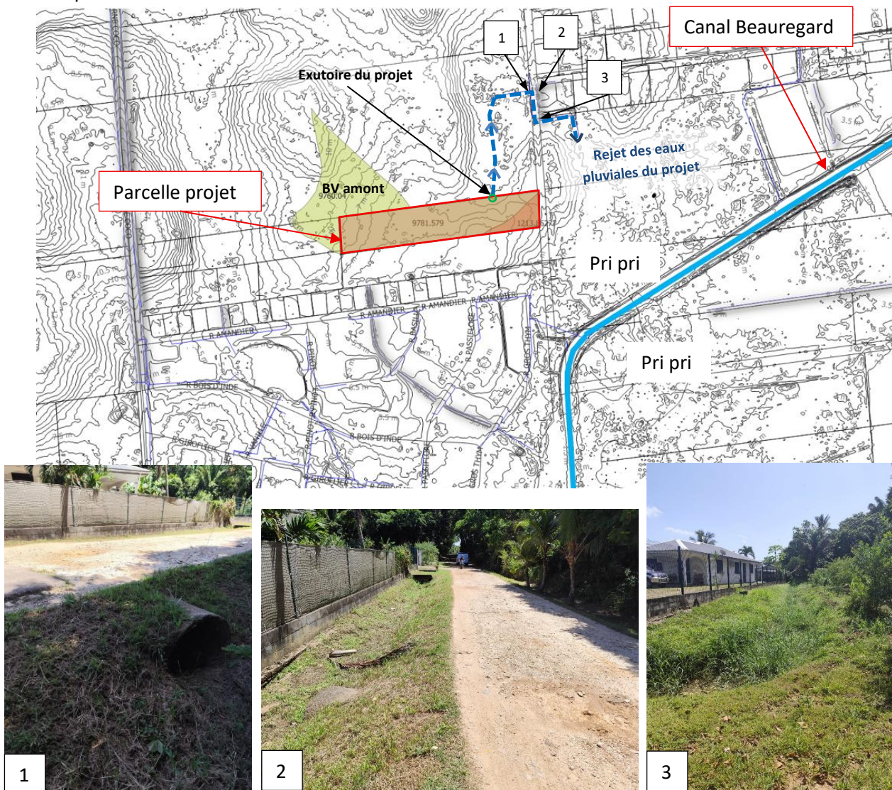
Figure 9 : Rejet des eaux pluviales au stade projet
