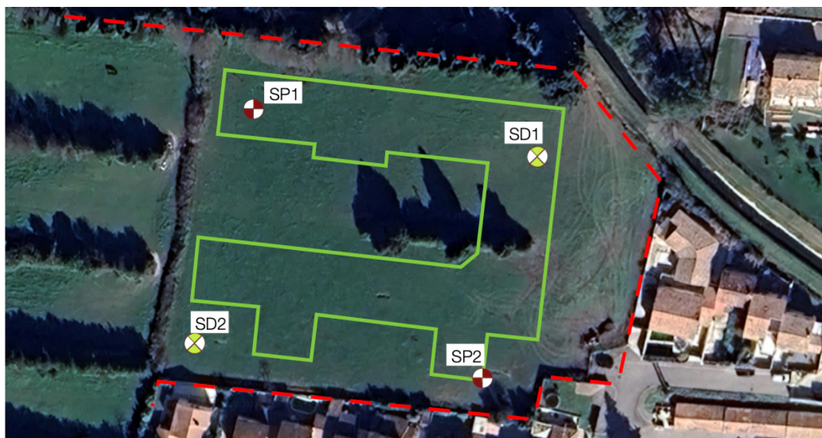
Figure 14 : Plan d'implantation des ouvrages piézométriques
