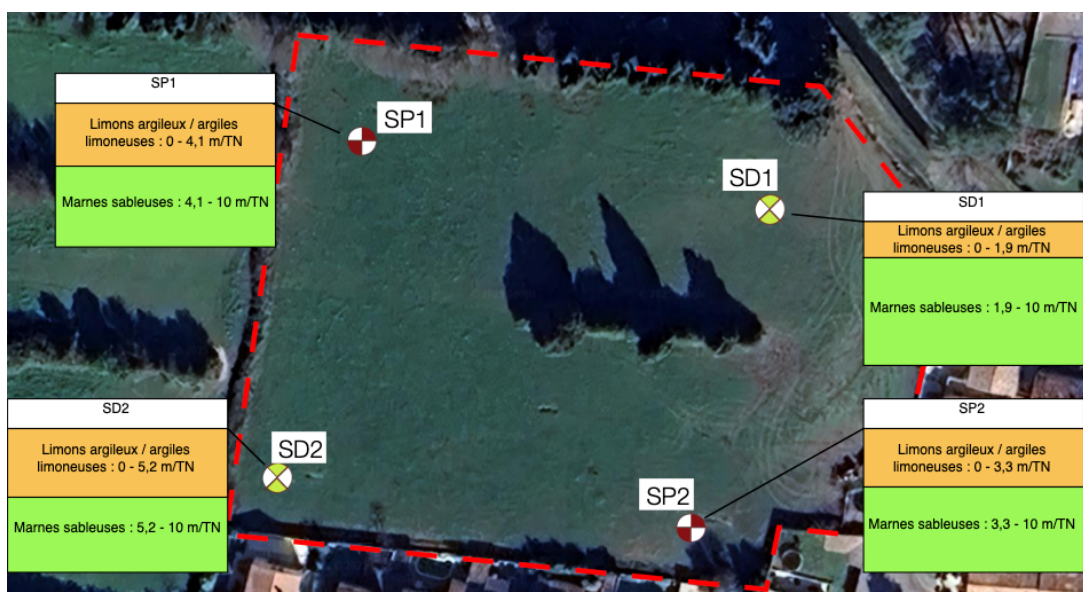
Figure 5 : Lithologie des sondages de SOL CONSEIL au droit du site
