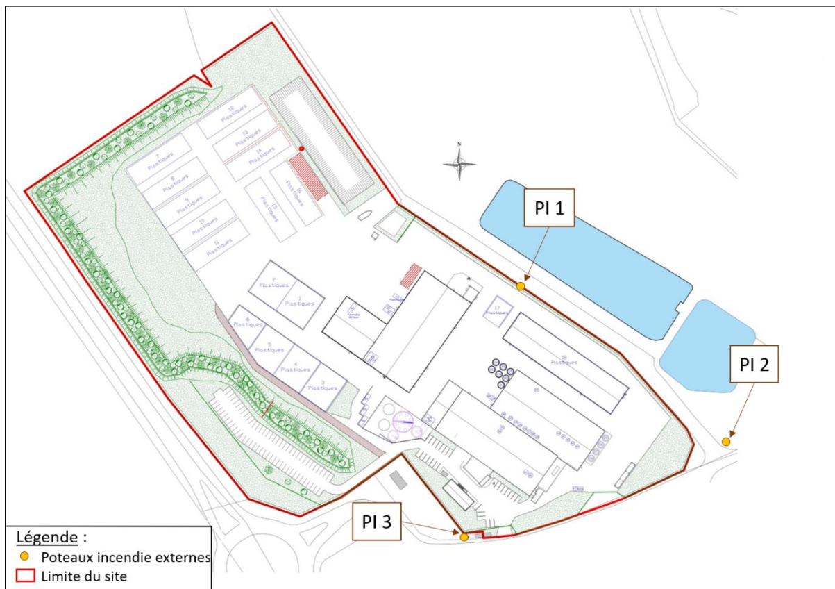
Figure 11 : Localisation des poteaux incendie externes au site
